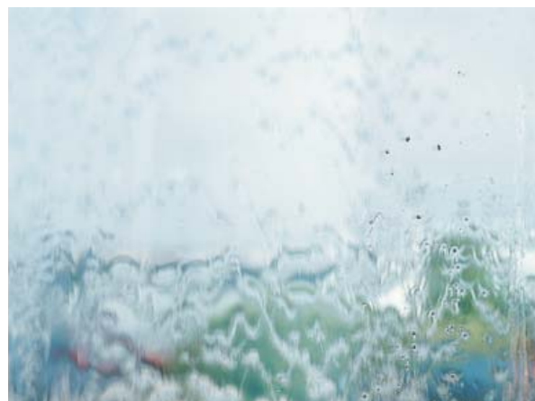
Bild 4 Da Schmutz auf Glas mit hydrophiler Beschichtung weniger Haftung findet, wird er bei auftreffendem Regen leichter weggespült als von unbeschichtetem Glas. Grundvoraussetzung dafür ist allerdings ein ausreichender Neigungswinkel der Verglasung.
