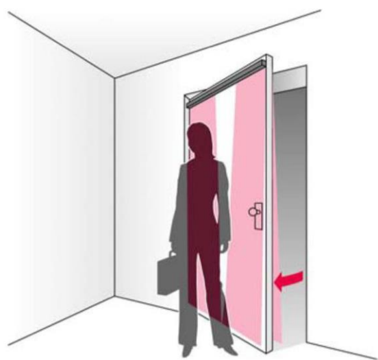
Bild 7 Infrarotvorhangsschiene zur Anwesenheitskontrolle (Quelle linkes Bild: ift Rosenheim, Quelle rechtes Bild: Firma Bircher Reglomat AG, CH-Beringen)
