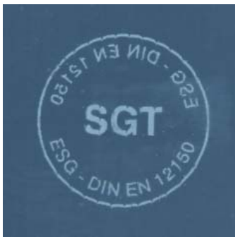
Bild 3 Muster eines Stempels für Einscheiben-Sicherheitsglas
