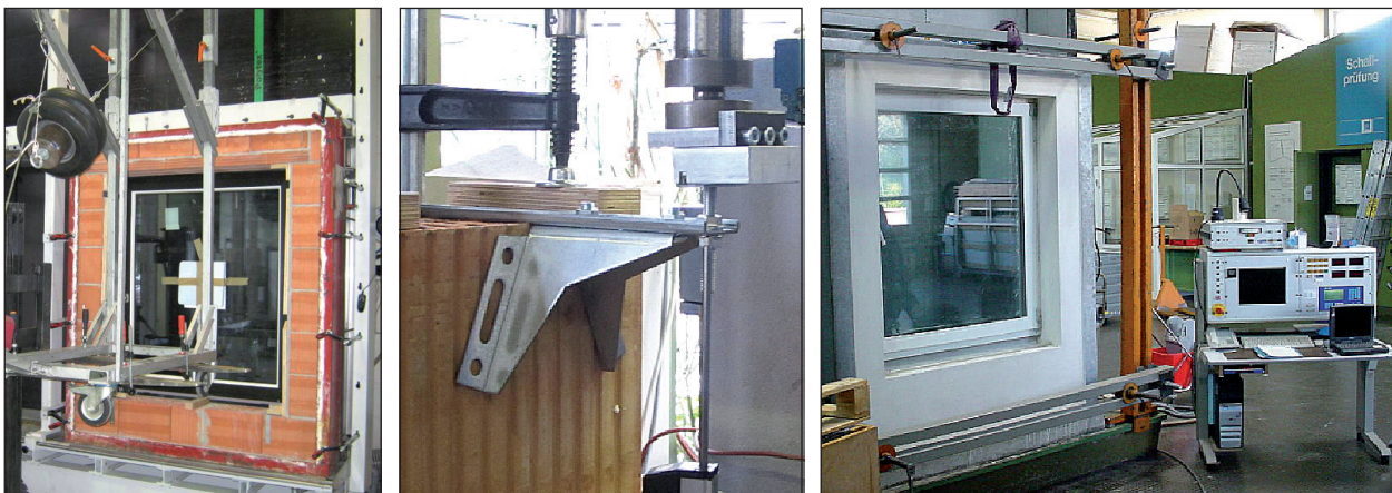
Bild 8 Eignungsprüfung von Montage- und Abdichtungssystemen gemäß ift-Richtlinie MO-01 Teil 1 und 2 (links Stoßbelastung, Mitte Belastung Konsole, rechts Windlast und Schlagregendichtheit)
