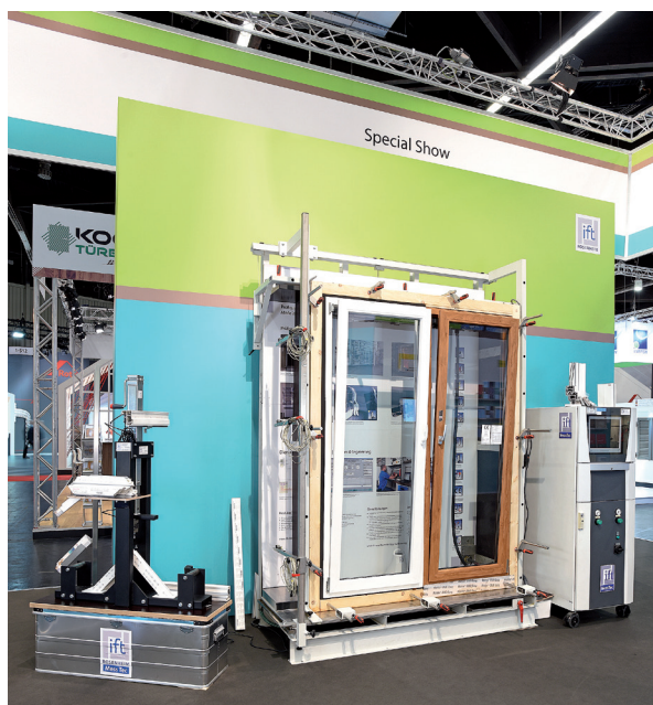
Bild 9 Der ift-Montagepass als Zeichen für einen geprüften Baukörperanschluss
