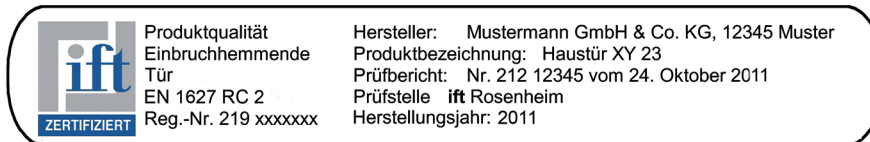
Bild 4 Kennzeichnungsschild für einbruchhemmende Türen nach DIN EN 1627
